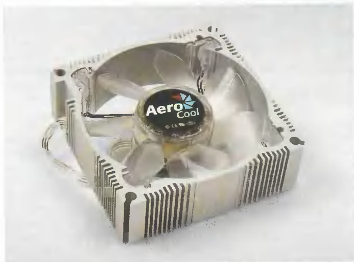
Вентилятор AeroCool Silence Aluminum. Когда выключен, совершенно не похож на моддинговый аксессуар. Светодиоды умело замаскированы.
